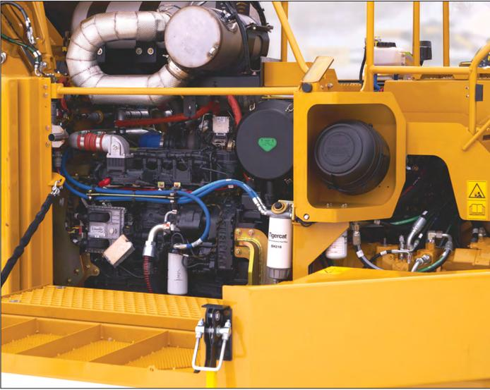
Le moteur et les pompes hydrauliques sont compartimentés et facilement accessibles. Accès facile à tous les éléments à entretenir quotidiennement.
