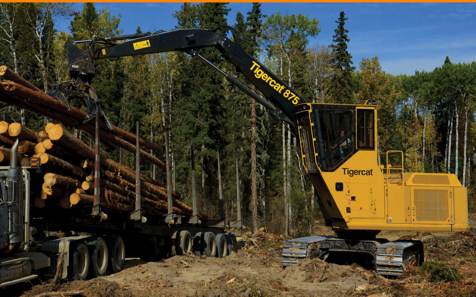
La chargeuse 875 est un transporteur forestier robuste, spécialisé et fiable, qui peut être configuré pour de nombreux usages, dont le chargement ou le façonnage du bois.
