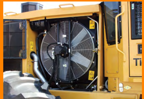
Enfriamiento de flujo cruzado de alta capacidad.
