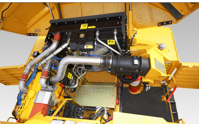
Le capot moteur escamotable de style coquille permet d'accéder facilement au moteur, aux vannes et aux composants du système de refroidissement. Les tuyaux et les fils sont disposés de façon ordonnée.
