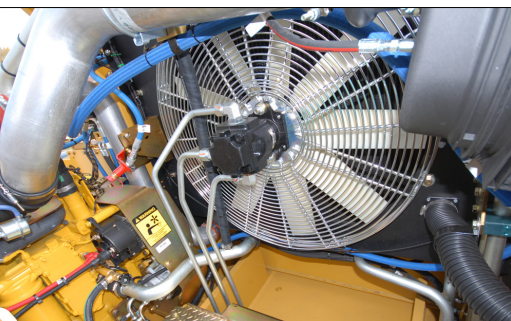
Refroidissement à haute capacité à vitesse variable
