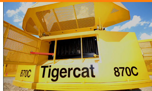
Prise d'air arrière éloignée de la zone d'évacuation des débris de la scie
