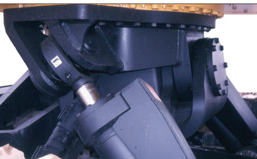
Gros axes, vérins et roulements à rouleaux coniques, plaque en acier épaisse
