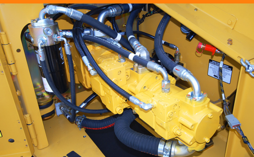
Colonne des pompes facilement accessible logée dans un compartiment séparé
