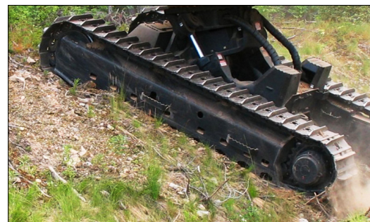
Longs bâts de chenilles bien écartés fournissant une excellente stabilité sur les pentes
