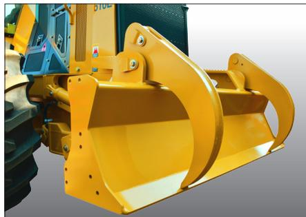
Greifzange an vorderer Schaufel zum Aufsichten von Kurzholz
