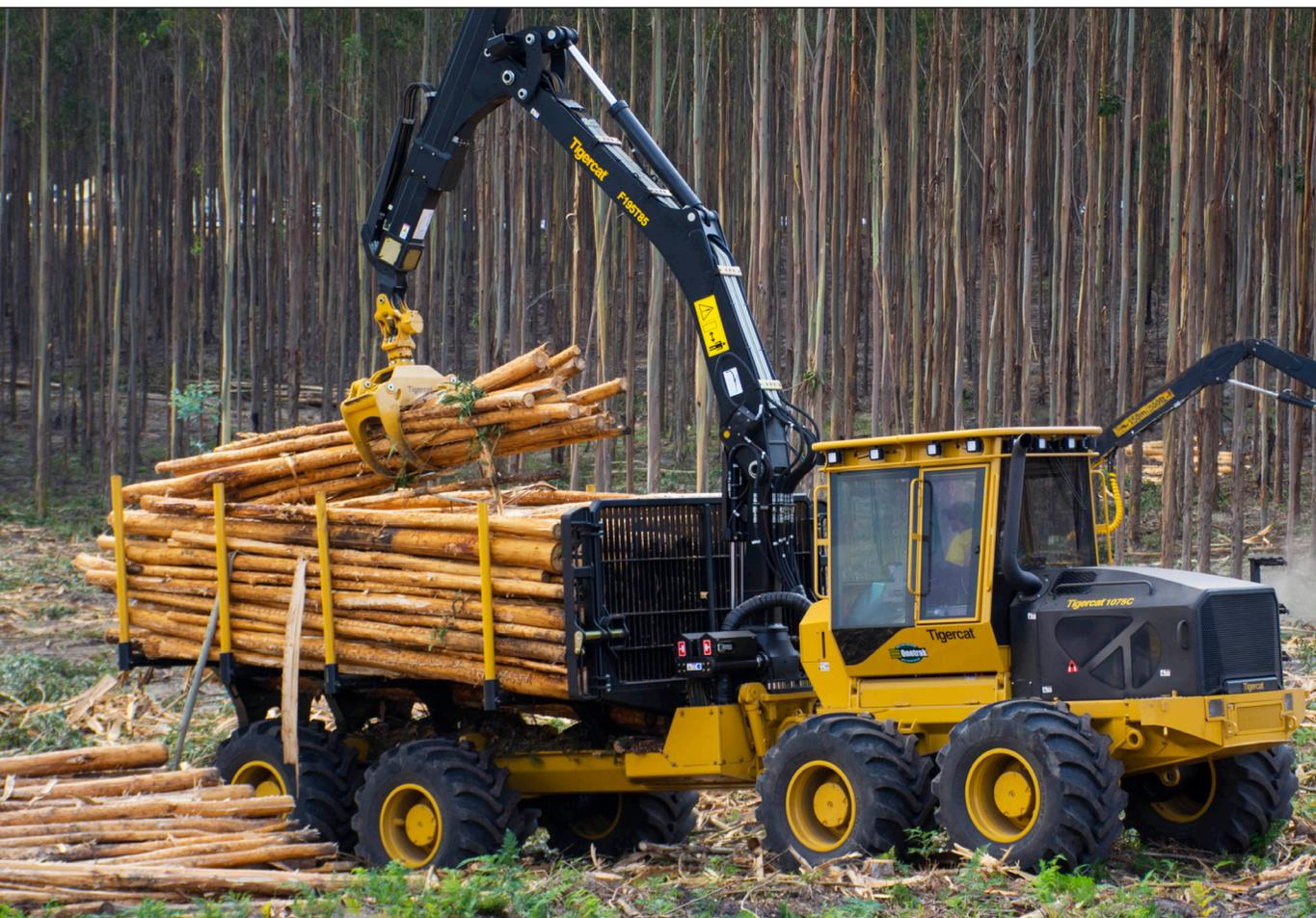
Оси тележки цапфы оснащены фрикционной муфтой блокировки дифференциала или MDDL (многодисковой блокировкой дифференциала). Это позволяет оператору включать и отключать блокировки дифференциала при движении машины для повышения производительности.
