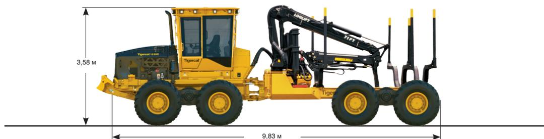
14-тонный форвардер Tigercat 1055C предназначен для тяжелых условий эксплуатации при выборочной рубке, сплошной рубке и участках по заготовке биомассы.
