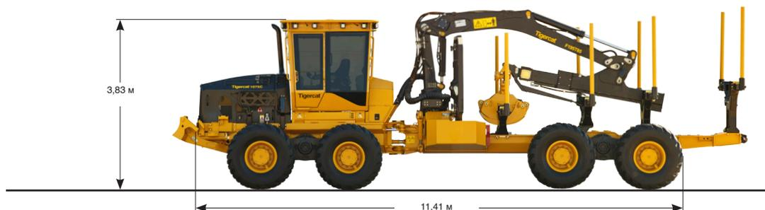
20-тонный форвардер 1075C предназначен для сверхтяжелых условий эксплуатации при сплошной рубке, перемещения на большие расстояния и для участков для рыхления.
