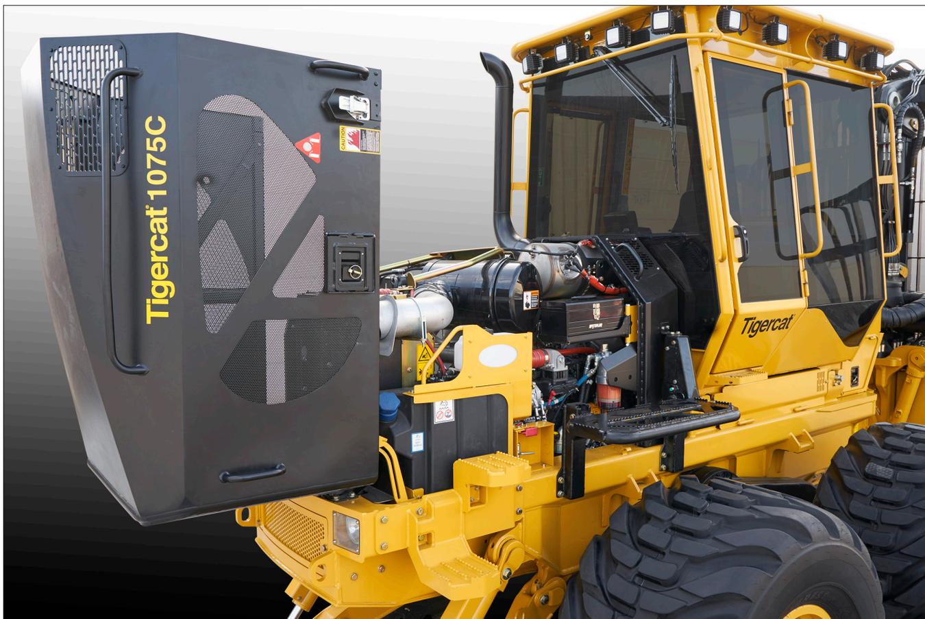
Легкий доступ к двигателю и всем ежедневным точкам обслуживания. Сильная стальная наклонная крышка моторного отсека защищает двигатель и компоненты системы охлаждения и выступает в качестве рабочей платформы при открытии. Никакой дополнительной страховки не требуется.
