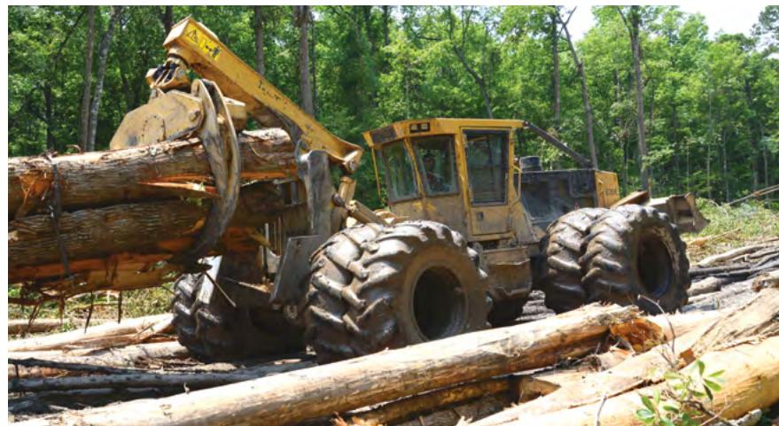
Все модели серии Е оснащены двойными или флотационными шинами в стандартной комплектации.
