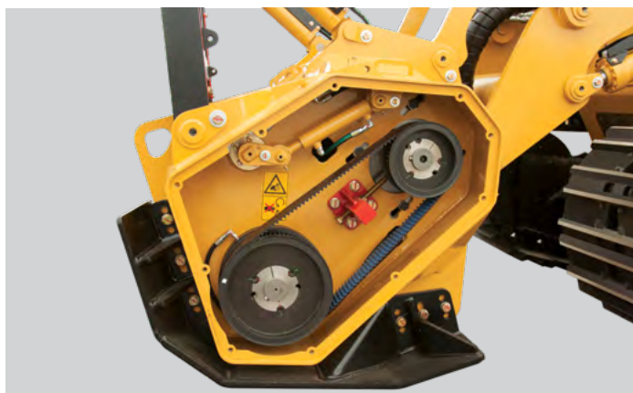
Fácil acceso a la correa de temporización.
