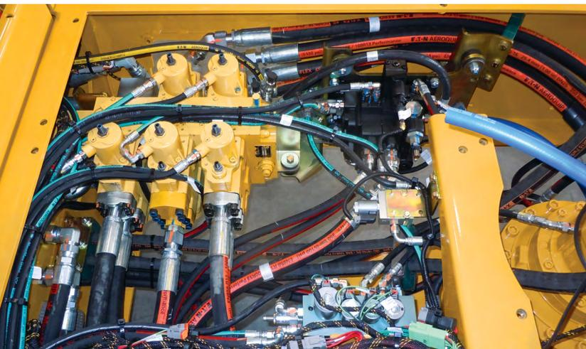
Todas las válvulas están ubicadas debajo de la plataforma de acceso para un acceso rápido y fácil con circuitos ordenados de sistema hidráulico y eléctrico.
