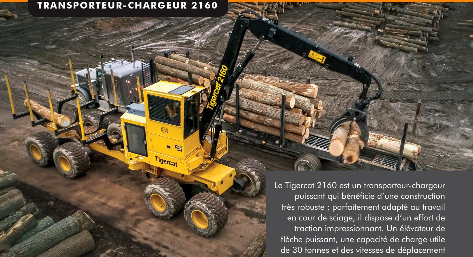
Le Tigercat 2160 est un transporteur-chargeur puissant qui bénéficie d'une construction très robuste ; parfaitement adapté au travail en cour de sciage, il dispose d'un effort de traction impressionnant. Un élévateur de flèche puissant, une capacité de charge utile de 30 tonnes et des vitesses de déplacement rapides le dotent d'une excellente productivité.
