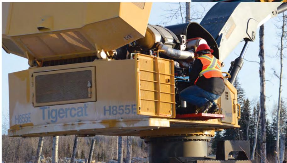
Portas basculantes com plataforma de serviço, permitindo acesso fácil e rápido ao motor.
