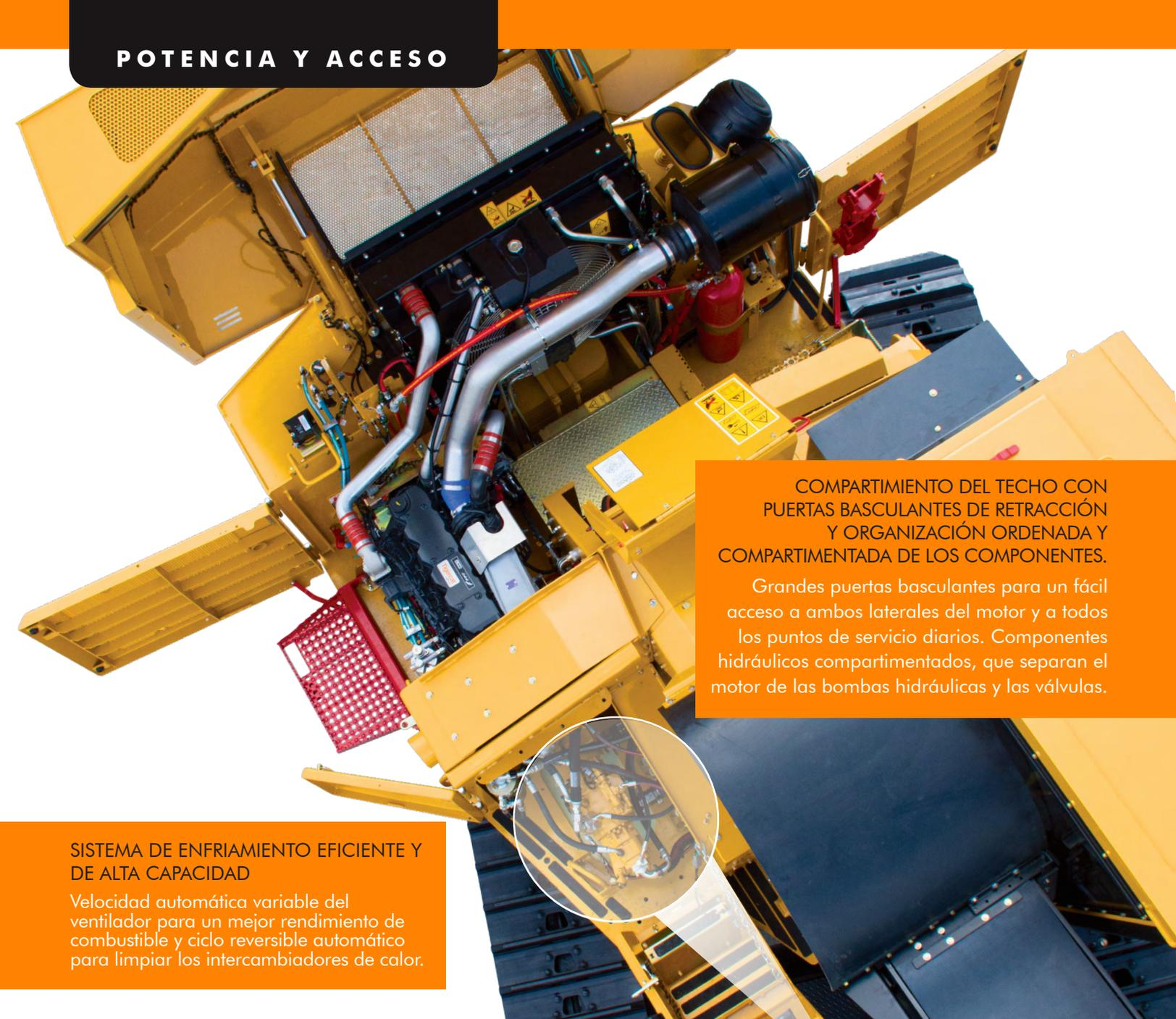
COMPARTIMIENTO DEL TECHO CON PUERTAS BASCULANTES DE RETRACCIÓN Y ORGANIZACIÓN ORDENADA Y COMPARTIMENTADA DE LOS COMPONENTES.
