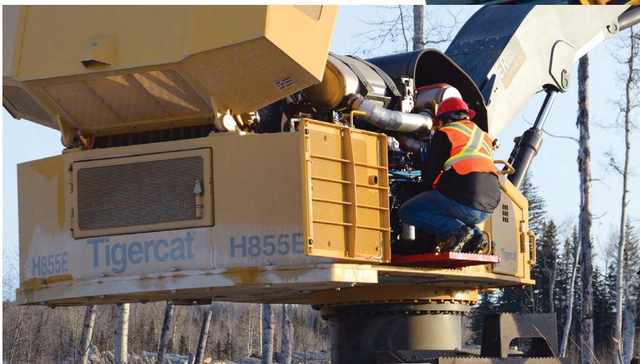
Puerta basculante con plataforma de servicio que permite un acceso rápido y sencillo al motor.
