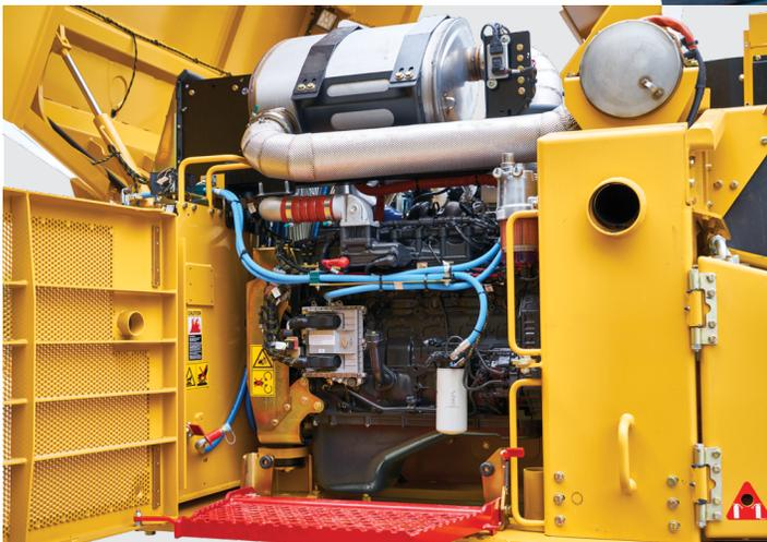
Portas basculantes com plataforma de serviço para acesso fácil e rápido ao motor.
