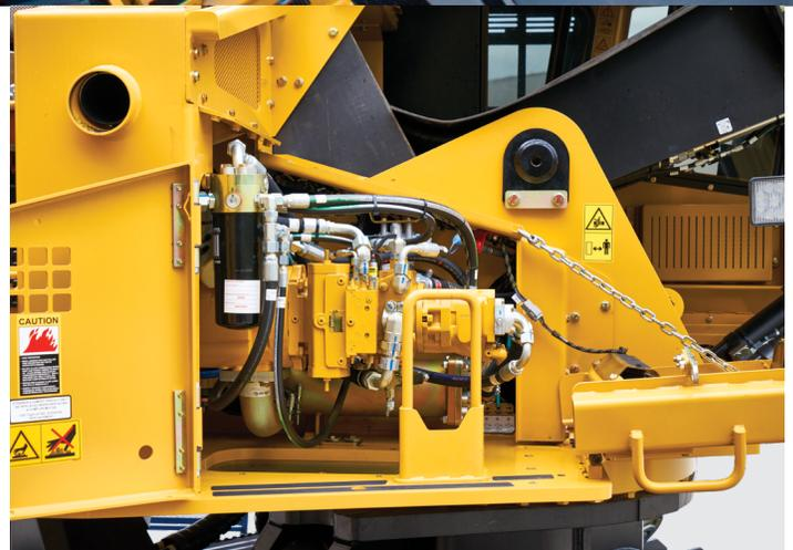
Acesso rápido e livre ao sistema hidráulico. Separado da área do compartimento do motor principal.
