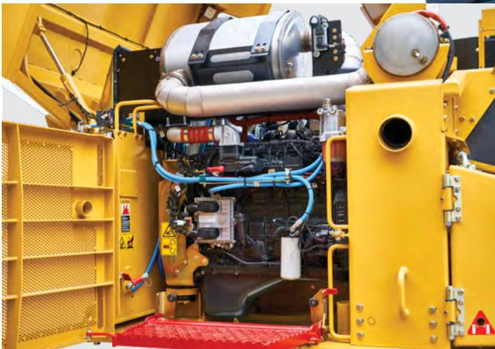
Puerta basculante con plataforma de servicio para acceder de forma rápida y sencilla al motor.
