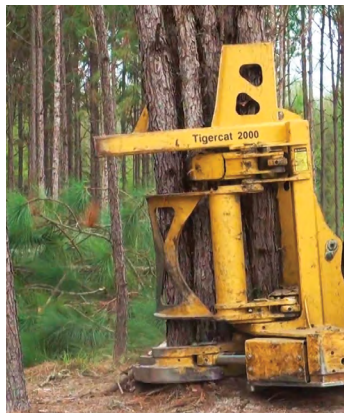
2000 НОЖЕВОЕ СРЕЗАЮЩЕЕ УСТРОЙСТВО
