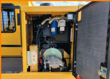
Puerta basculante de acceso a las bombas y los filtros hidráulicos.
