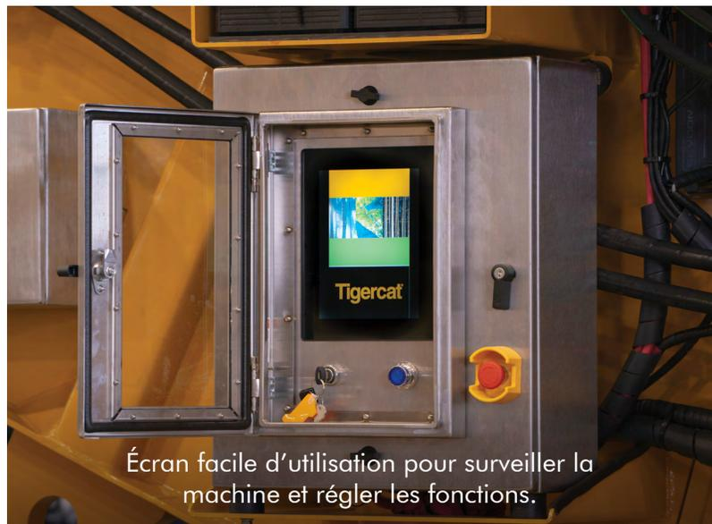
Écran facile d'utilisation pour surveiller la machine et régler les fonctions.
