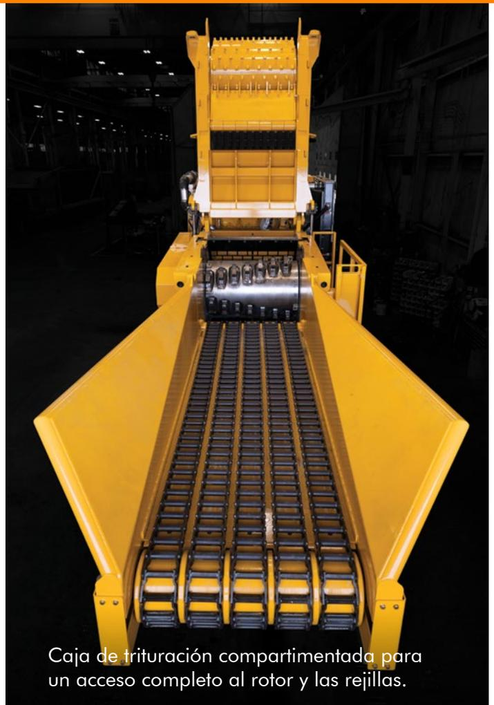
Caja de trituración compartimentada para un acceso completo al rotor y las rejillas.
