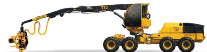
**Particulièrement adaptée aux coupes de diamètres variables, la 534 est optimisée pour correspondre aux caractéristiques de haute performance de l'abatteuse-façonneuse 1165.**
