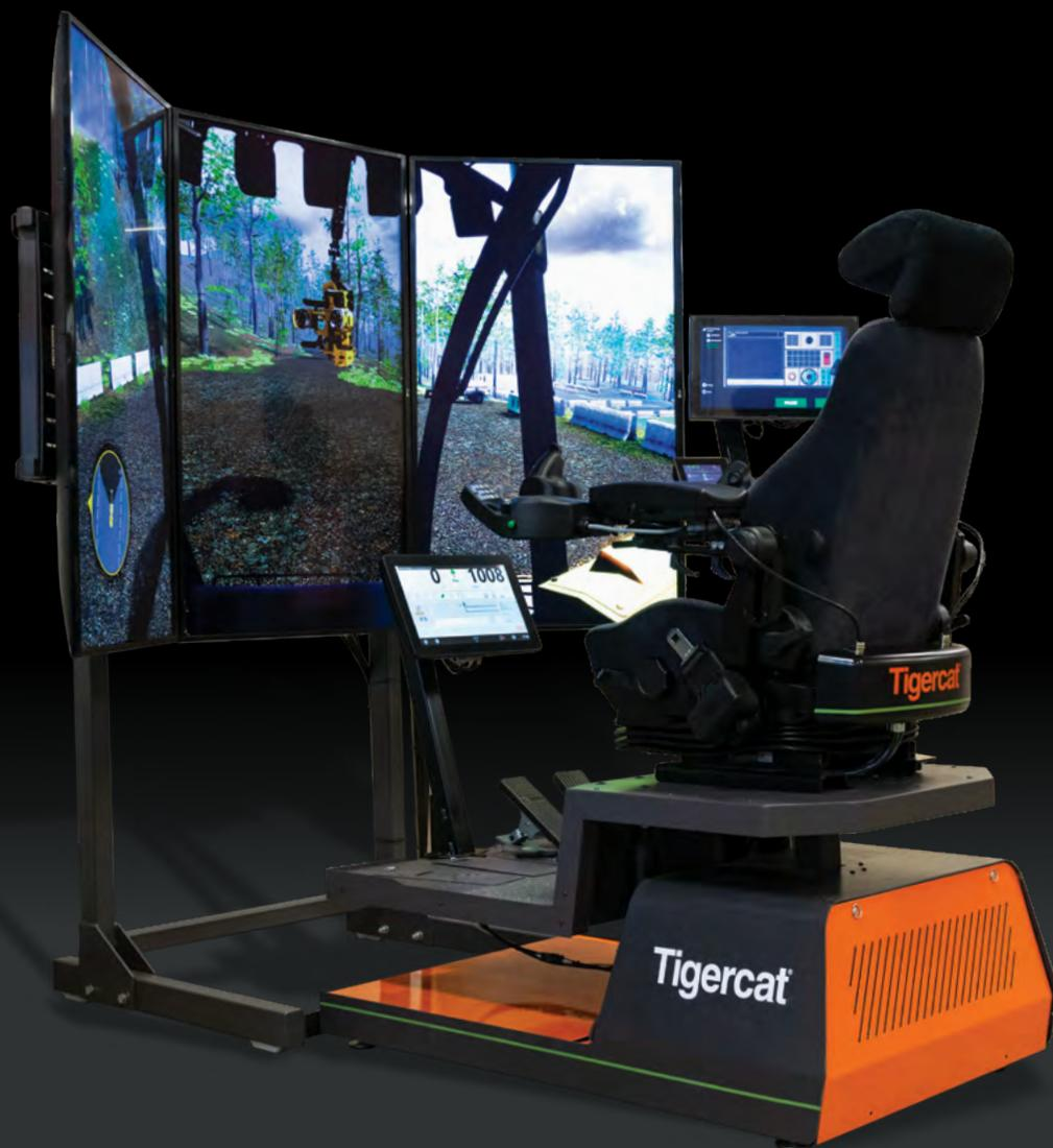
O SIMULADOR TIGERCAT FORNECE UMA SOLUÇÃO VIRTUAL DE TREINAMENTO PARA OPERADORES SOBRE CORTE NO COMPRIMENTO COM UM AMBIENTE OPERACIONAL ULTRARREALISTA. O SISTEMA AVANÇADO É CAPAZ DE SIMULAR OS CONTROLES E A OPERAÇÃO DO FORWARDER 1075C E DO HARVESTER 1165 COM TRACÇÃO NAS OITO RODAS E EQUIPADO COM O CABEÇOTE DE COLHEITA 534.
