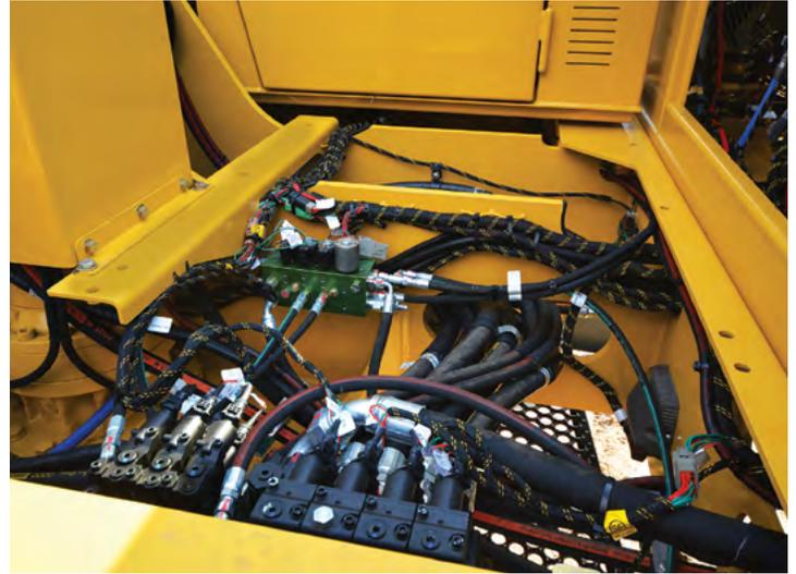
► Toutes les vannes sont situées sous la plateforme pour un accès simple et facile grâce à un acheminement hydraulique et électrique soigné.
