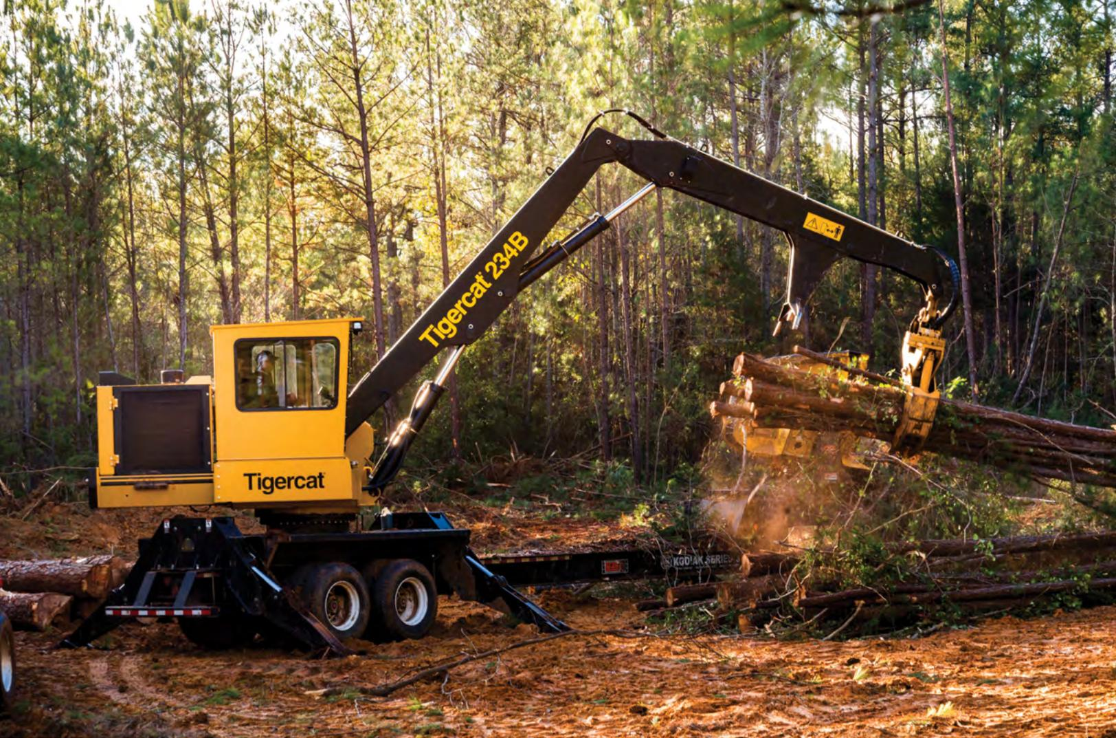
**LES ÉLÉMENTS HYDRAULIQUES EFFICACES ASSOCIÉS À UN SYSTÈME À BOUCLE FERMÉE ET ROTATION CONTINUE FOURNISSENT UNE ALIMENTATION SIMULTANÉE À TOUTES LES FONCTIONS DE LA MACHINE, POUR OBTENIR DES PERFORMANCES ÉLEVÉES, UNE EXCELLENTE RÉPONSE ET DES ÉCONOMIES DE CARBURANT.**
