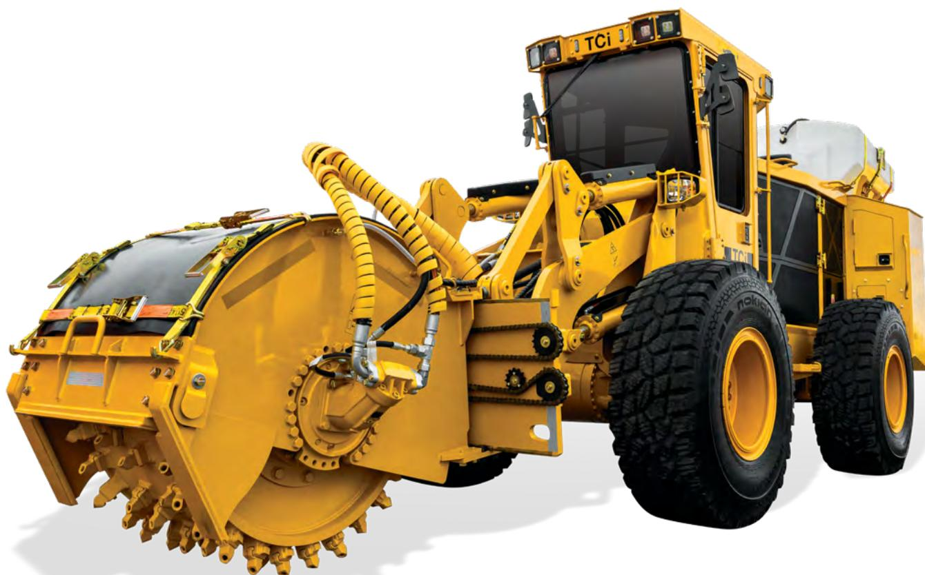
LA TRANCHEUSE URBAINE TCI 730 EST CONÇUE SPÉCIFIQUEMENT POUR OUVRIR DES TRANCHÉES DE LARGEURS ET PROFONDEURS VARIÉES DANS DU BITUME, DU BÉTON ET DES REVÊTEMENTS DE CHAUSSÉE EN ACIER RENFORCÉ. LA MACHINE CREUSE DES TRANCHÉES SOUS LE NIVEAU DU SOL, TOUT EN PULVÉRISANT LE MATÉRIAU ET REMBLAYANT EN UN SEUL PASSAGE. ELLE REMPLACE AINSI PLUSIEURS OPÉRATIONS CLASSIQUES EN UNE MÊME ÉTAPE.
